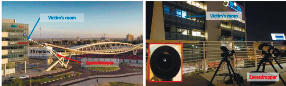
上图:“灯泡电话”的流程图:被窃听房间的声音①在悬挂的灯泡②表面产生振动。窃听处通过望远镜③将光电传感器(传感器)对准悬挂的灯泡。光学信号经由类比数位转换器④从光电传感器采样,并使用算法处理得到复原的声学信号⑤。下图:窃听装置(位于人行天桥上)与悬挂的LED灯泡(位于附近建筑第三层的办公室)之间的距离为25米。
