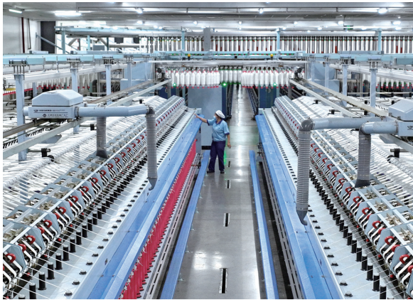
昨天拍摄的南通大生集团忙碌的“数字化纺纱车间”。该车间拥有国内纺织行业第一条全流程国产设备示范生产线,用工仅需15人/万锭,且生产效率提高10%以上,真正实现了自动化、智能化、用工少、效能高。记者许丛军
