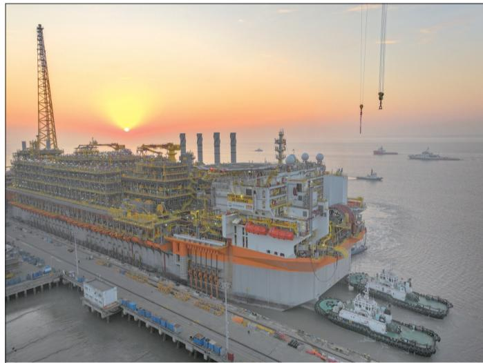
昨天,全球最大的海上浮式生产储油船M026 FPSO在南通海事局的精心护航下,从启东中远海运海工码头启航,标志着其22.5年的服役生涯正式开启。M026 FPSO设计日生产能力达18万桶石油,可处理1200万标准立方米天然气,最大储存能力为140万桶原油,是目前世界上吨位最大、储油量最大的新型海上浮式生产储油装置,被誉为“海上移动炼油厂”。记者许丛军
