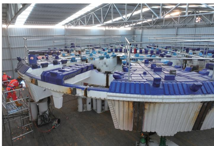
昨天,在海太长江隧道工程施工现场,工人对盾构机“江海号”刀盘进行焊接作业(无人机照片)。
