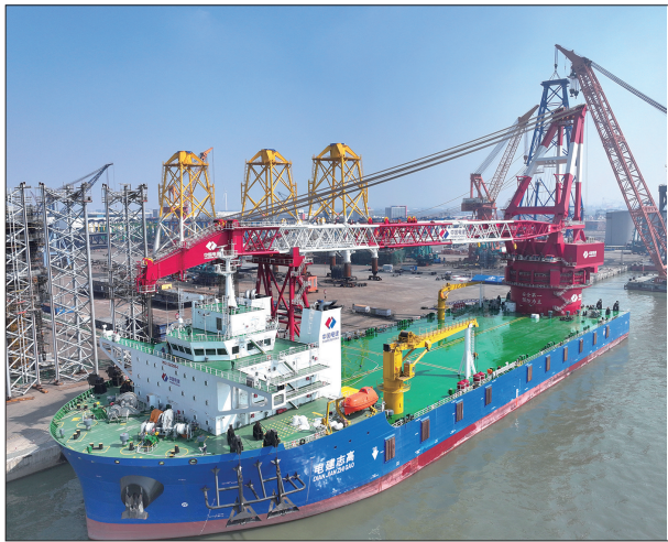
昨天拍摄的由上海振华重工南通振华重装承建的中国电建3600吨全回转起重船“电建志高”号。该船由我国自主研发,具备长距离自航能力,主要用于海上风电桩基础施工(含导管架)、升压站及大型海上构件安装等海上工程。记者许丛军
