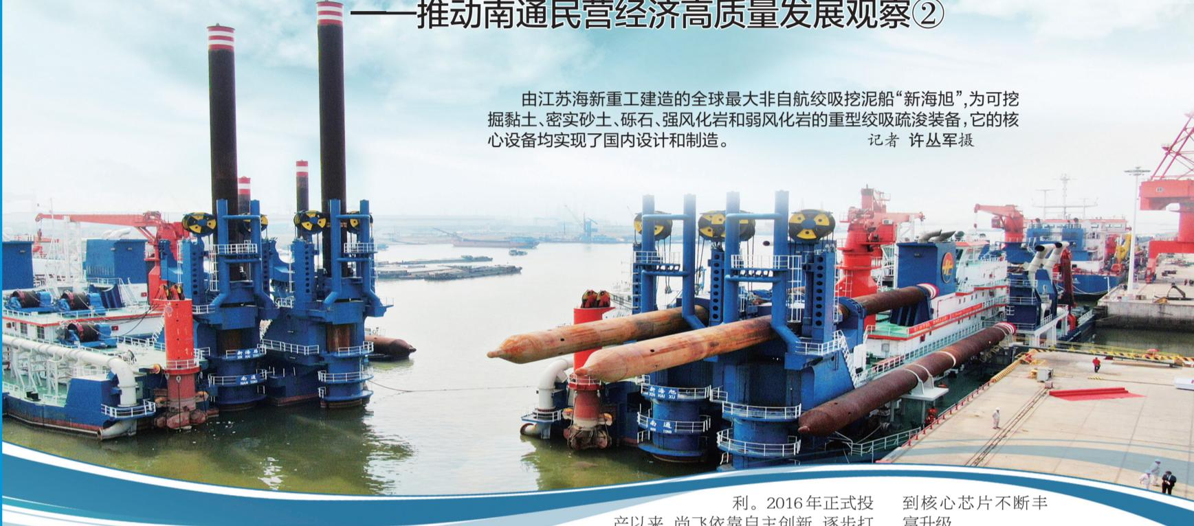
由江苏海新重工建造的全球最大非自航绞吸挖泥船“新海旭”，为可挖黏土、密实砂土、砾石、强风化岩和弱风化岩的重型绞吸疏浚装备，它的核心设备均实现了国内设计和制造。
