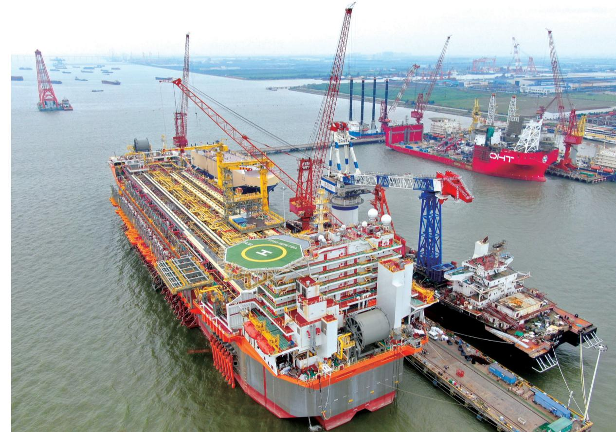
3日记者在招商工业海门基地拍摄的世界最大、最先进的FP-SO(海上浮式生产储卸油装置)。这个被称为“海上炼油工厂”的FPSO将于8日正式交付。
