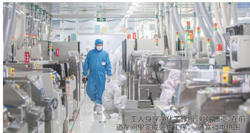
工人身穿净化工作服,戴好口罩,在前道车间里完成装片工序。通富微电供图
