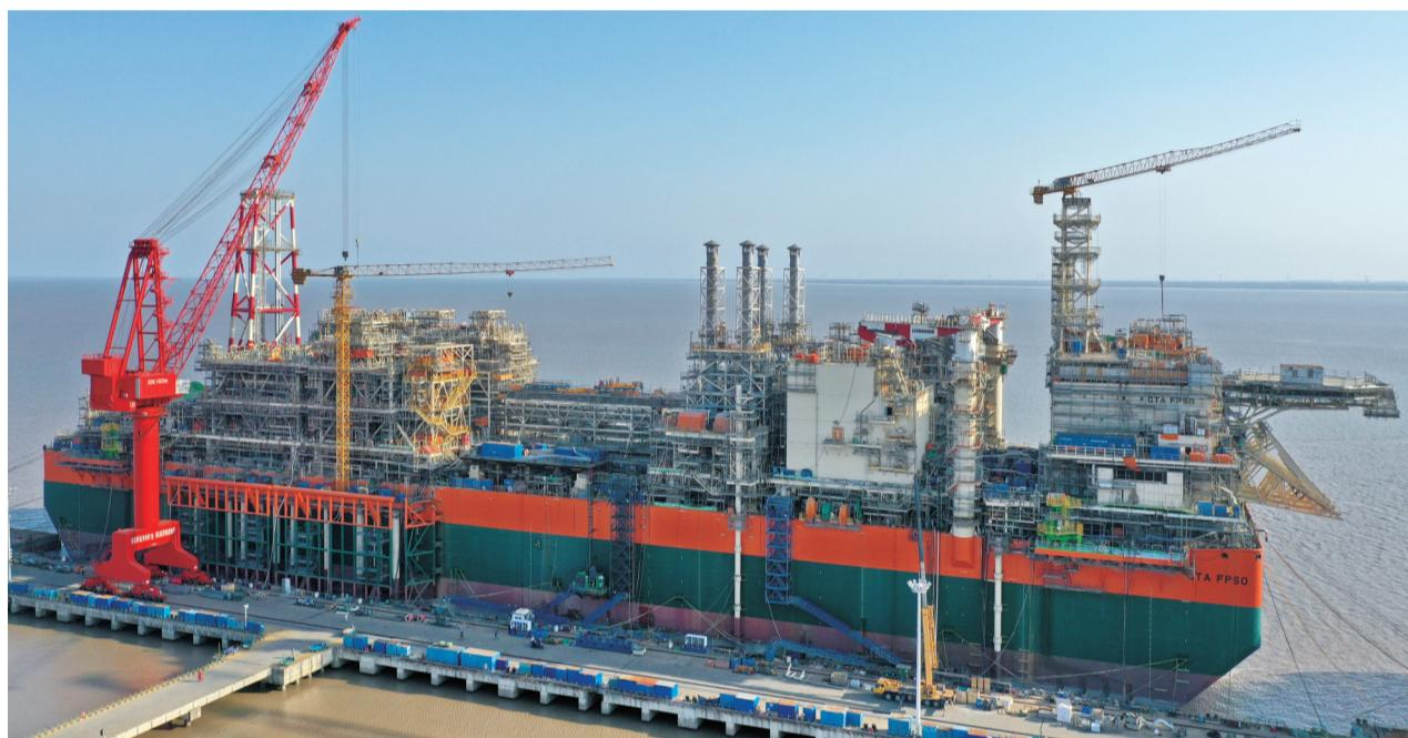
近日,启东中远海运海工N999 FPSO项目顺利实现发动机车关键节点,标志着该项目机舱动力系统的调试正式拉开帷幕。N999 FPSO是中国船企首次为非洲项目建造的浮式生产储卸油船,启东中远海运海工负责该项目主船体和生活区的设计、采购和建造(EPC)以及上部模块的建造。该船长270米,总宽54米,型深为31.5米,集油气生产、处理、储卸、外输功能及系泊定位于一身,建造完成后将远赴非洲开展作业。
