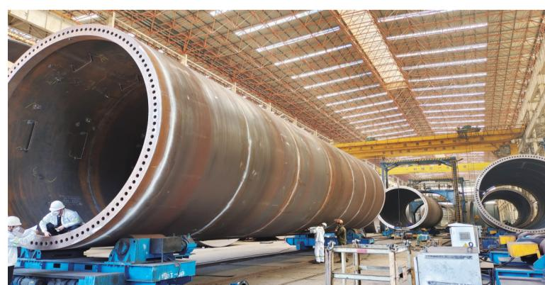
泰胜蓝岛风塔生产车间内,工人正在紧张地为塔筒的筒节进行出车间
