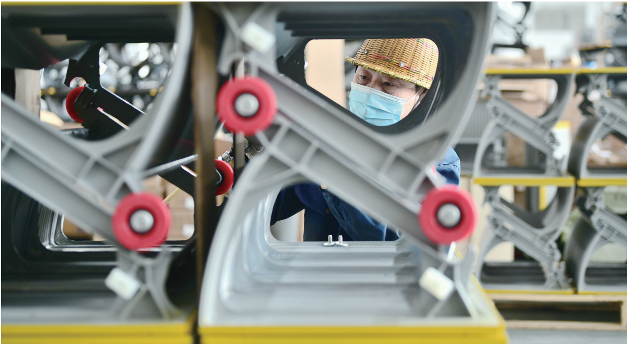
15日，位于海安市胡集街道的南通江中光电有限公司生产车间，员工正加紧生产铝合金扶梯梯级。临近年底，该市电梯产业链各企业生产线“火力全开”赶订单，奋力完成全年目标任务。
