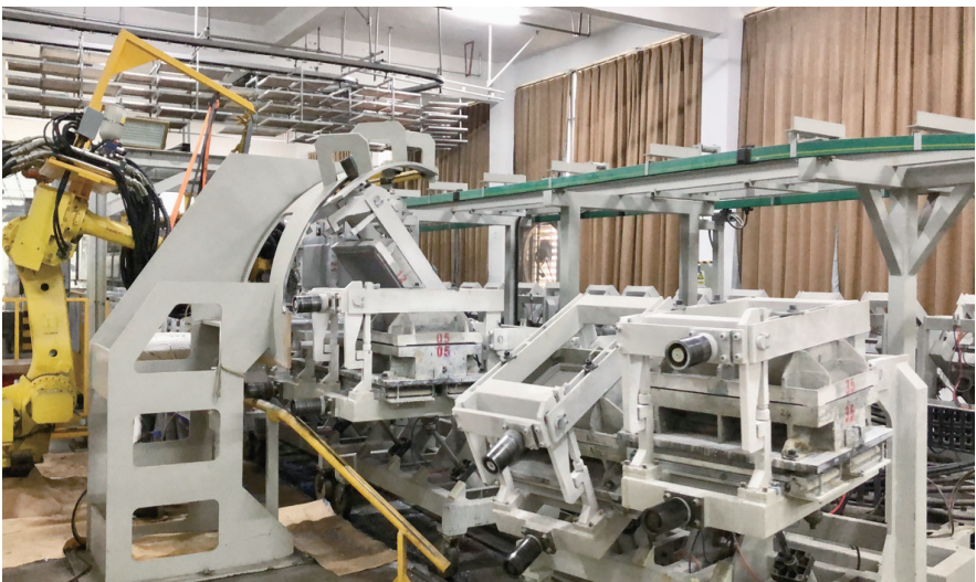
梦百合家居模塑车间内，机械手正在往全自动生产线上轮转的模具里灌注原料。 王玮丽摄
