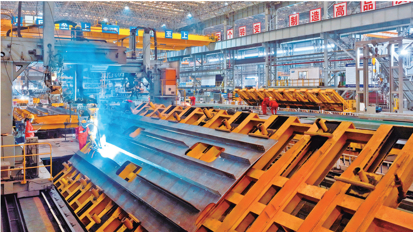
25日,在中铁山桥有限公司的智能焊接车间内,机器人正在进行钢构件焊接。近年来,中铁山桥以国家重点桥梁工程建设为契机,全面提升钢梁制造的数字化、自动化、网络化、智能化制造水平,数字化制造生产线首次将桁梁杆件自动化焊接率提升至93%,作业人员减少33%,大幅提升和稳定了产品质量和劳动效率。CFP供图
