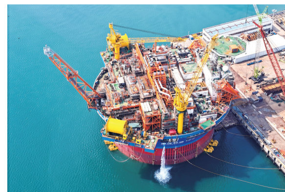
昨日，由我国自主设计建造的亚洲首艘圆筒型“海上油气加工厂”——“海洋石油122”浮式生产储卸油装置(FPSO)在海油工程青岛岛地进行海上倾斜试验及调试(无人机照片)。“海洋石油122”被称为“超级能源碗”，可连续在海上运行15年不回坞。新华社照片
