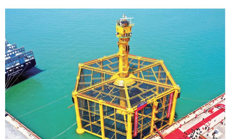
昨日,在山东青岛拍摄的“深蓝2号”大型智能深海养殖网箱。该网箱全潜状态设计养殖水体达9万立方米,是目前我国应用海域最远、适用水深最深、养殖水体最大、功能性能最先进的深远海养殖网箱装备,搭建一体化数字化管理模式,逐步实现深远海无人养殖功能。新华社照片
