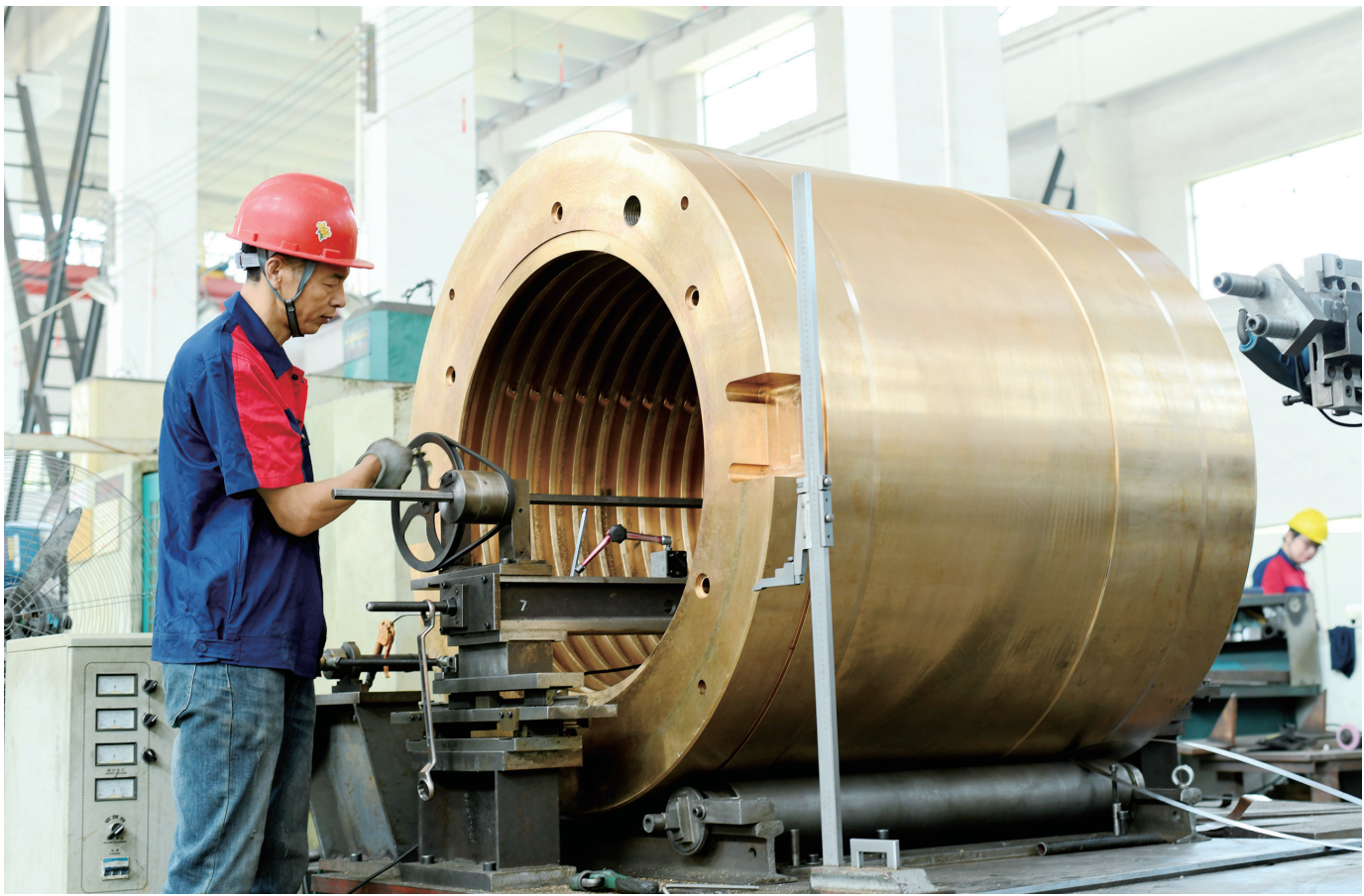
23日,在位于海安高新区的恒益滑动轴承有限公司生产车间内,工人正在加紧赶制钢板轧机用的螺母螺丝。其中,单个分别重10吨的铜螺母、重20吨的钢螺丝独步国内市场,产品替代进口部件,正申报2024年江苏省首台(套)重大装备认定。 顾华夏摄
