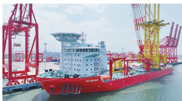
上周,由江苏韩通重工有限公司建造的48524吨自航式全回转起重船“宝威大力神”轮在通州湾吕四起步港区沪通码头交付开航。“宝威大力神”轮是一艘风电施工船,具备对单机容量15兆瓦及以上大型海上风电机组进行多种形式基础施工的能力。
