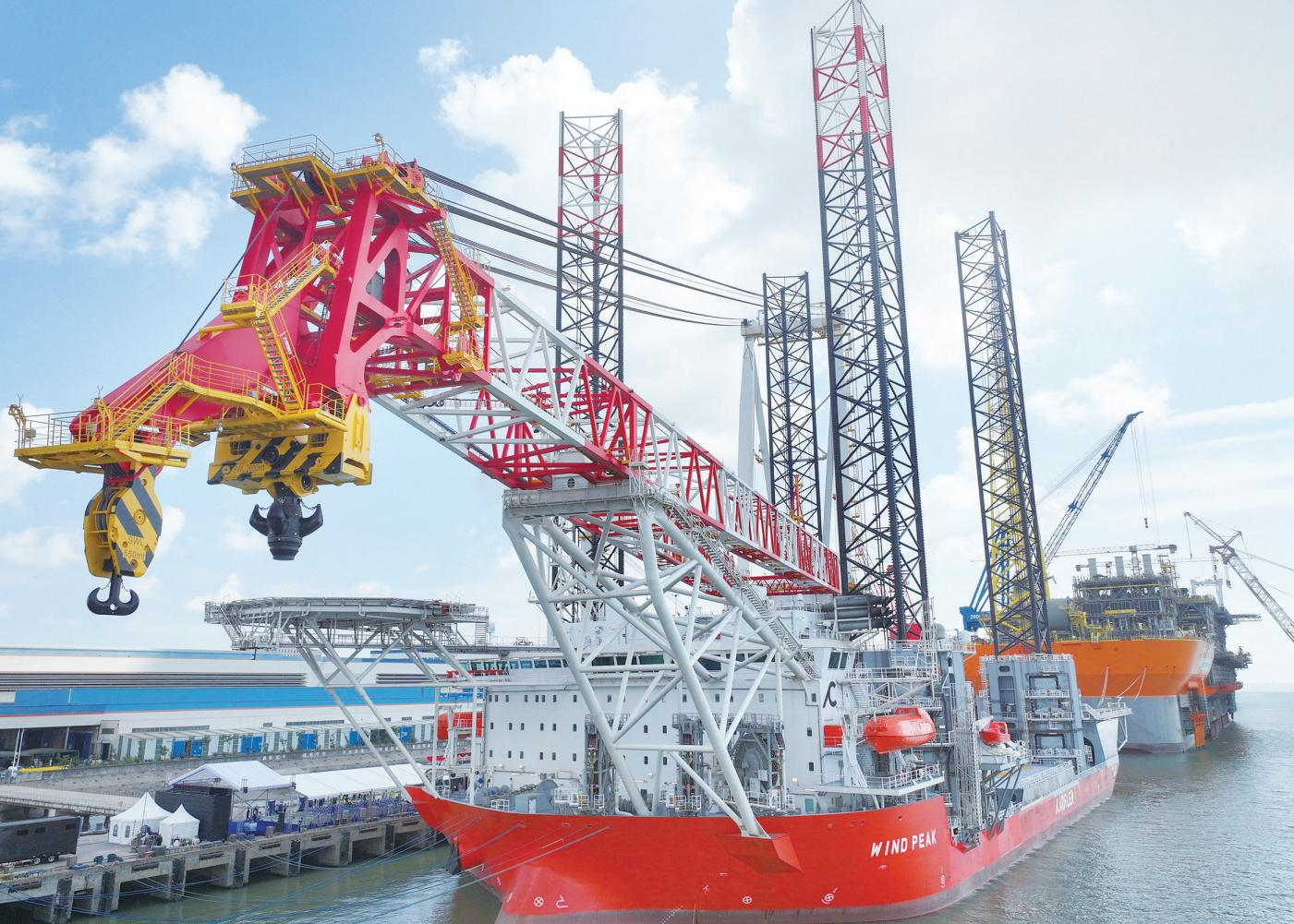
昨天，启东中远海运海工为丹麦船东定制的首艘NG20000型风电安装船正式命名为“Wind Peak”。该船拥有5600平方米的甲板空间，有效载荷超过1.76万吨，主吊起重能力超过2500吨，首次采用油电混合动力，生活区可容纳130人。一次可运输并安装7套完整的15MW或5套20MW以上的风机，是目前全球技术规格最高、最先进的自升式海上风电安装船。
