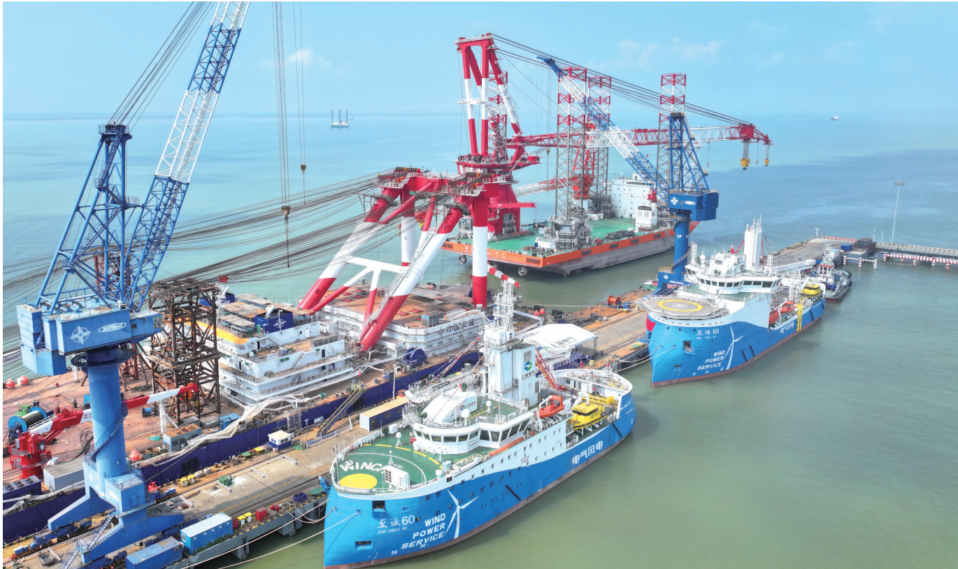
16日，上海振华重工为上海电气风电建造的亚洲首制风电运维母船“至臻100”“至诚60”在启东海工船舶工业园命名交付。两艘风电运维母船均是可在深远海风场进行连续运维作业的专用高效船舶，配备DP2动力定位系统，自持力均在30天以上，满足无限航区要求。
