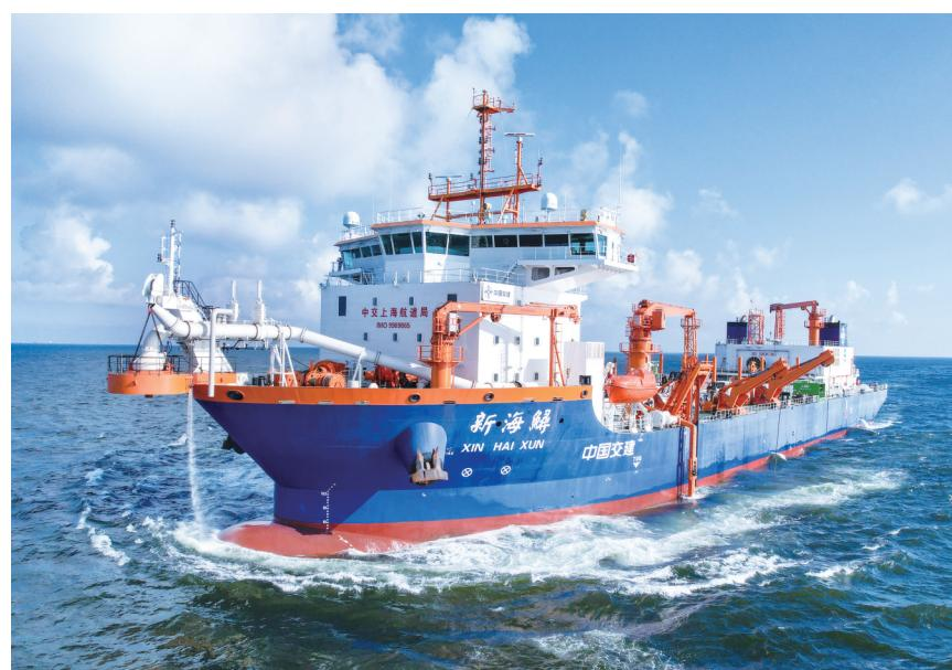
本报讯（记者黄海）27日晚，上海振华重工建造的全球最大舱容、国内首艘15000方舱容双燃料动力耙吸式挖泥船“新海鲟”轮，在振华启东海工码头鸣笛解缆，正式开赴上海洋山港进行疏浚作业（上图 通讯员吴锡松摄）。
