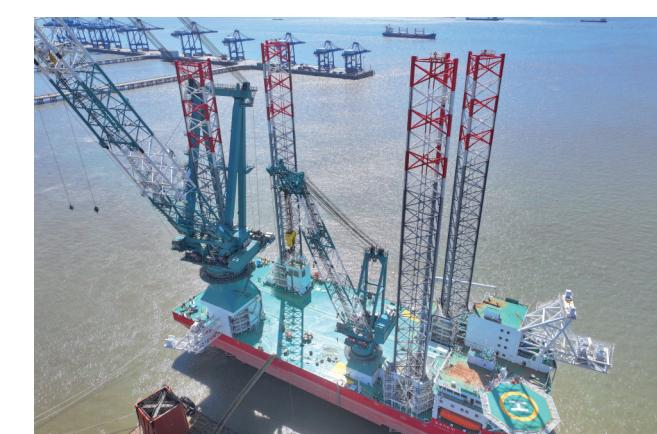
昨日，完成全程升降试验的“海洋风电91”1600吨风电安装平台停泊在振华码头。该平台是我国自主研发设计具有完全自主知识产权的自航自升式风电安装平台，也是振华重工南通传动公司继成功交付三峡“白鹤滩”等6套升降系统后，顺利完成交付的第7套。
