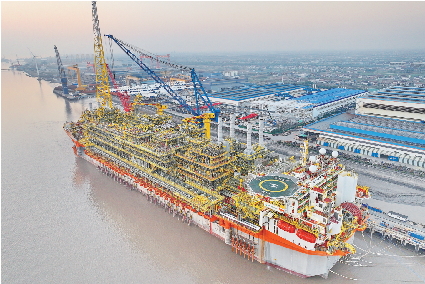
1日晚在启东海工船舶园拍摄的世界上最大吨位新型海上浮式生产储油船。该船舶体长334米，型宽60米，设计日生产18万桶石油，可处理1200万标准立方米天然气，注水能力为每天25万桶，最大储存能力为140万桶原油，是名副其实的“海上移动炼油厂”。项目建成后将于约1900米深的海域，可同时连接15口油井进行油气开发作业。
