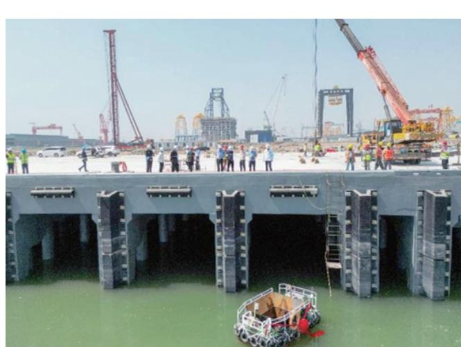
18日,润邦重机通州湾装备制造基地码头,一艘外形憨态可掬的小艇——“长润18”无人智慧化抛石平台正式下水。该平台全长3.8米,可携带1.5吨抛石料,设计航速为1.5米/秒,集“萌系外观”与“硬核实力”于一身,以远程操控、智能导航、精准抛投等“黑科技”,破解高桩码头排架间人工抛石效率低、均匀性差、安全风险高的行业难题,标志着港口施工从“人力时代”迈向“无人自主”的智能化模式。
